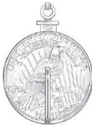
Dólar de prata do poder com cortevista revelando o pino interno. Phil Franke
